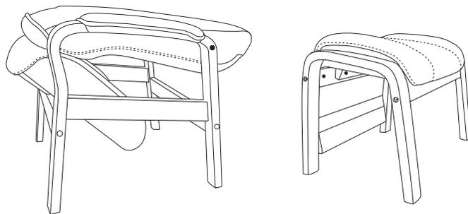
Bitte beginnen Sie danach, alle sichtbaren Schrauben und Schrauben an Stuhl und Ottomane zu befestigen. Verwenden Sie die Werkzeuge VI und VII
